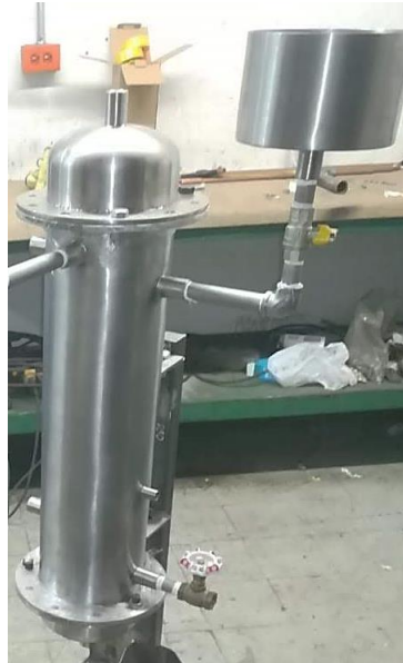
Figura 26. Unión de carga y descarga del intercambiador grande.
