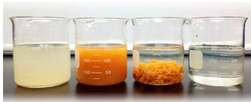
Figura 3. Tratamiento químico mediante coagulantes y floculantes
