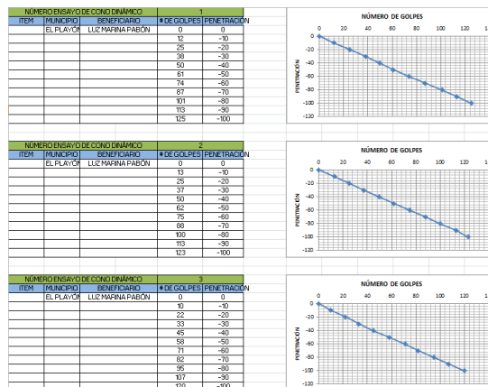
Figura 6. Ensayo cono dinámico. Fuente: Autor
