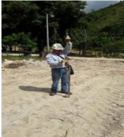
Figura 6. Ensayo cono dinámico. Fuente: Autor
