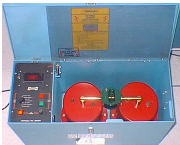
Figura 10. Chispómetro Hipotronics, análisis rigidez dieléctrica
