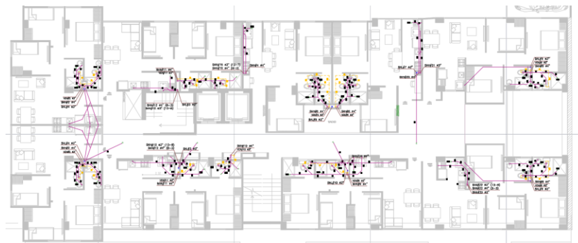
Figura 41 Planos récord red sanitaria Edificio Akau25
