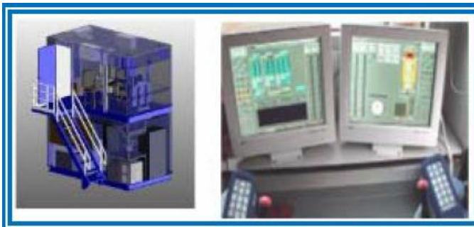
Figura 32: Cabina de control.
