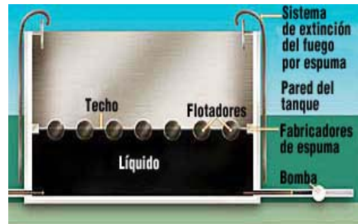
Figura 3. Tanque de techo flotante
