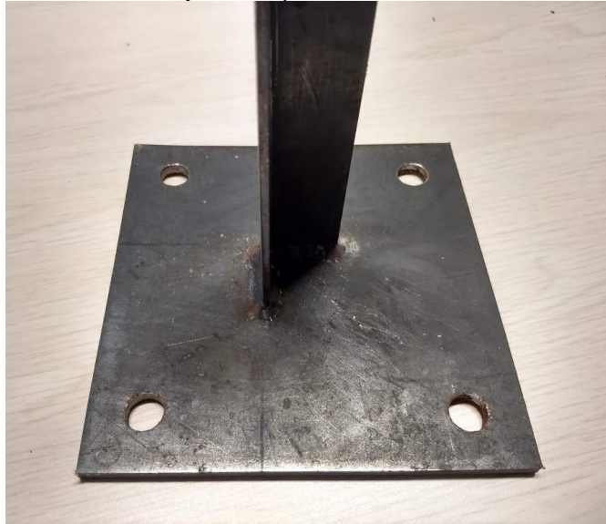
Figura 12. Construcción sistema de sujeción al piso.
