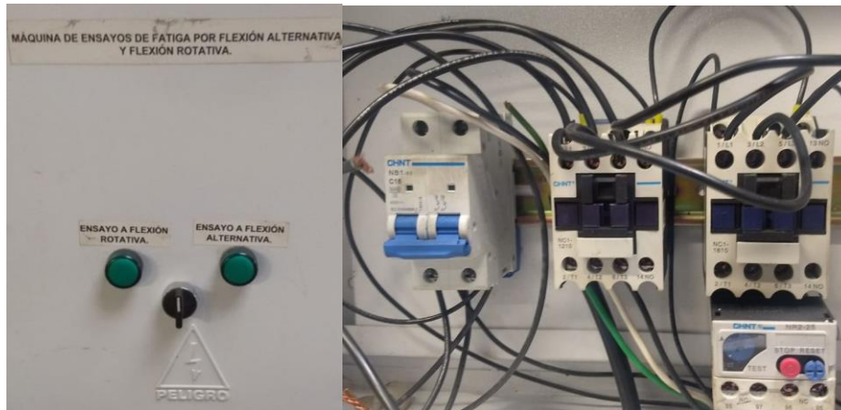
Figura 14. Sistema eléctrico inicial.
