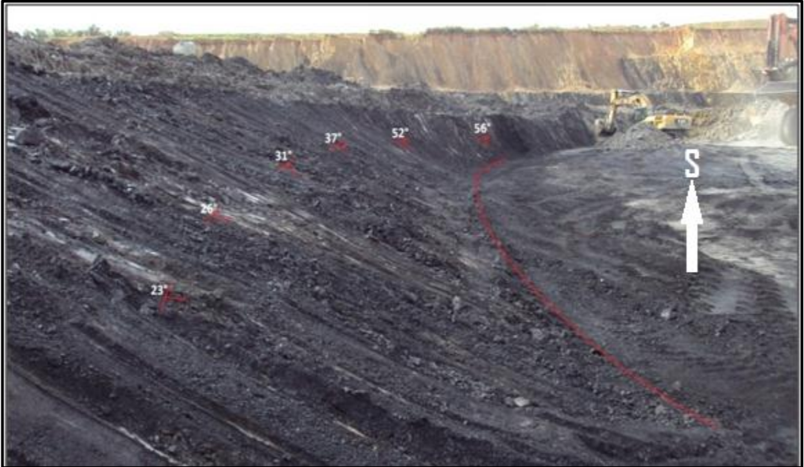
Figura 28: Cambio de buzamiento en el manto C340-C345 en el nivel 9 del sector C-D
