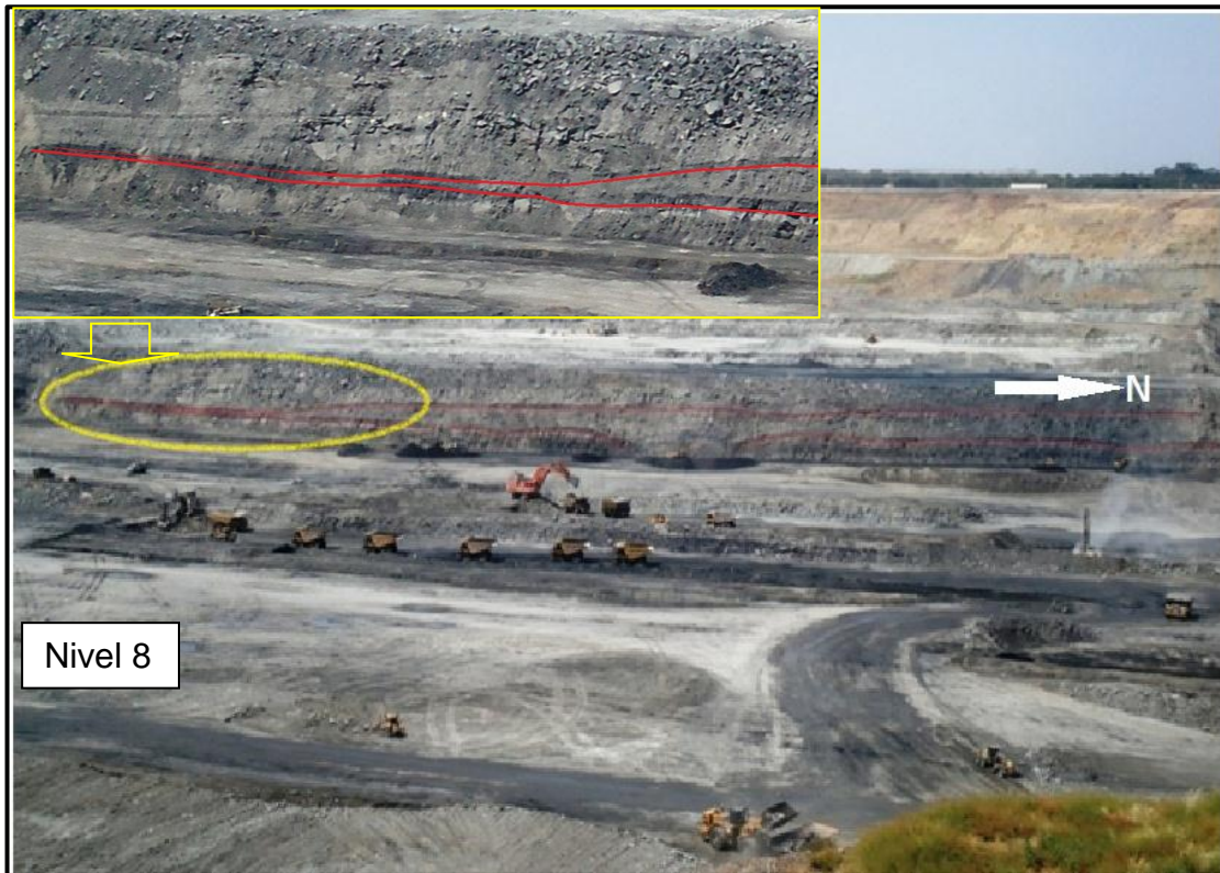
Figura 26: Vista panorámica de los mantos C340 (inferior) C345 (superior) en el nivel 8 mostrando la disminución del espesor en la roca entre manto.
