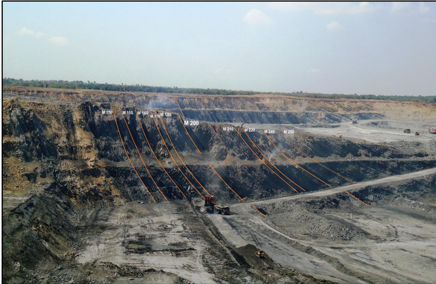
Figura 11. Vista panorámica de algunos mantos de carbón en la pared alta del nivel 8 del sector C.
