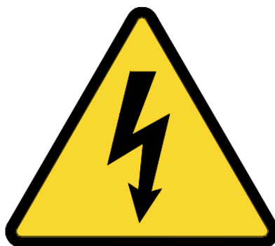
Figura 58. Señal de riesgo eléctrico.
