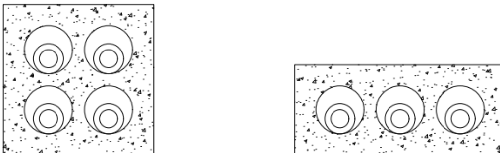
Figura 18. Representación de ductos subterráneos.
