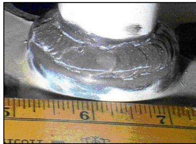
Figura 9. Unión soldada, punto crítico para Vibración-Fatiga.
