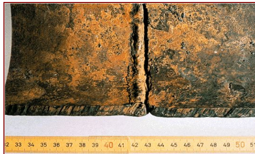
Figura 6. Grieta producida por HTHA.
