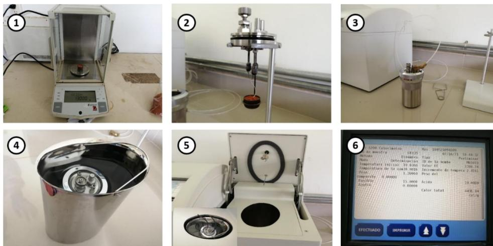
*Nota.* 1. Pesaje de la muestra, 2. Amarre de la fibra de celulosa, 3. Inyección de oxígeno, 4. Introducción bomba calorimétrica en cubeta con agua destilada, 5. Cubeta dentro del calorímetro 6. Valor calorífico.
