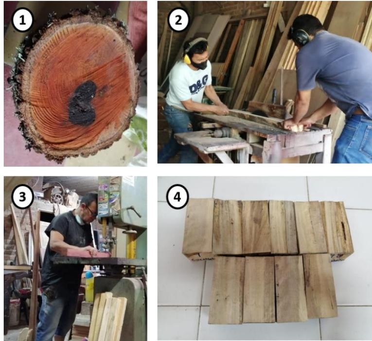
*Nota.* 1. Trozas de madera, 2.Descortezado de la madera, 3. Transformación de la madera, 4. Probetas.
