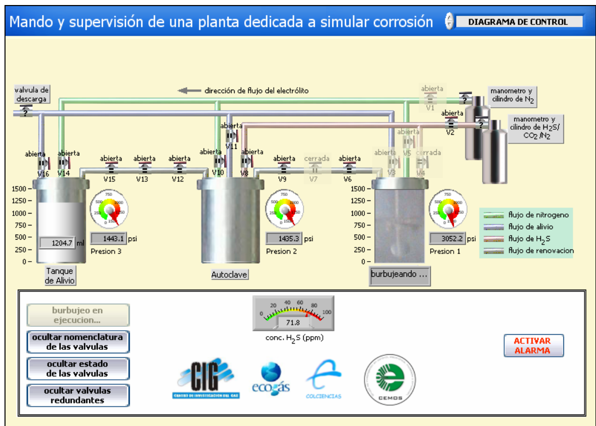
Figura 40. Pantalla típica de la etapa de burbujeo del software de mando y supervisión.
