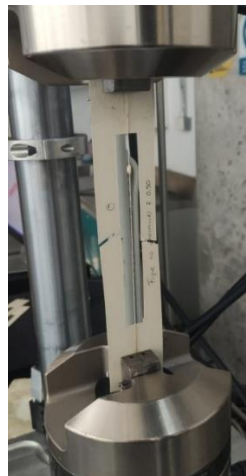
Montaje de las probetas en la máquina de ensayos
