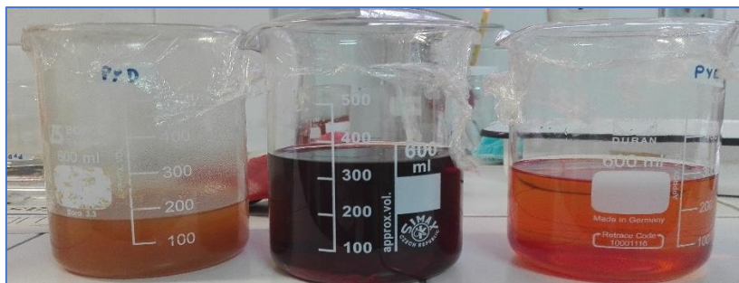
Foto 1. Aceite aviar crudo, aceite aviar esterificado y biodiesel aviar.
