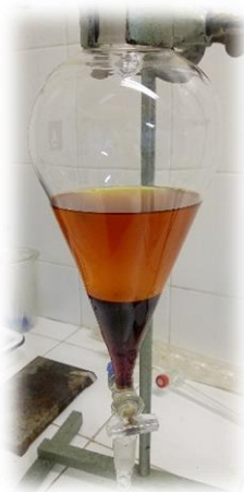
Foto 4. Decantación después de la RT, fase superior BA y fase inferior glicerina.
