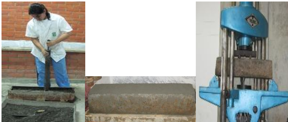
Figura 17. Elaboración y ensayo a flexión vigas
