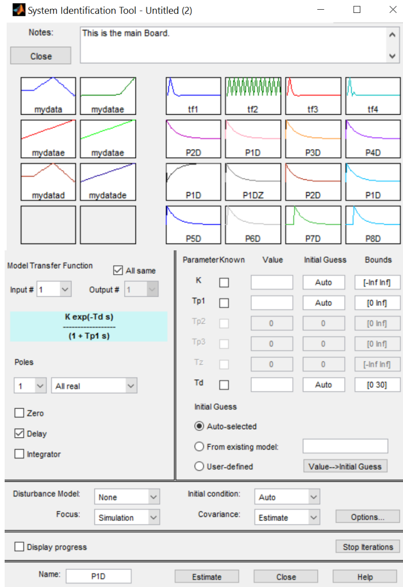
Figura 11. Obtención de modelos tipo funciones de transferencia
