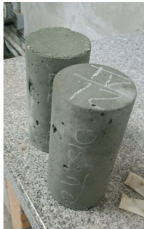
Figura 59. Probetas para ensayo de resistencia
