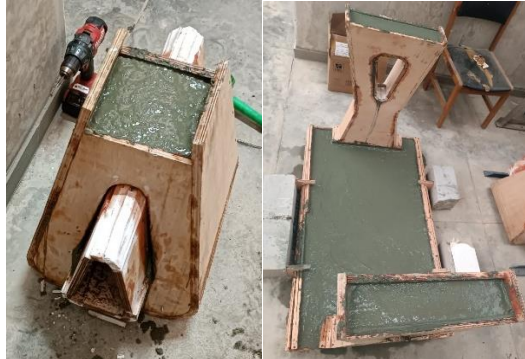
Moldes con concreto (material final) Fuente el autor.
