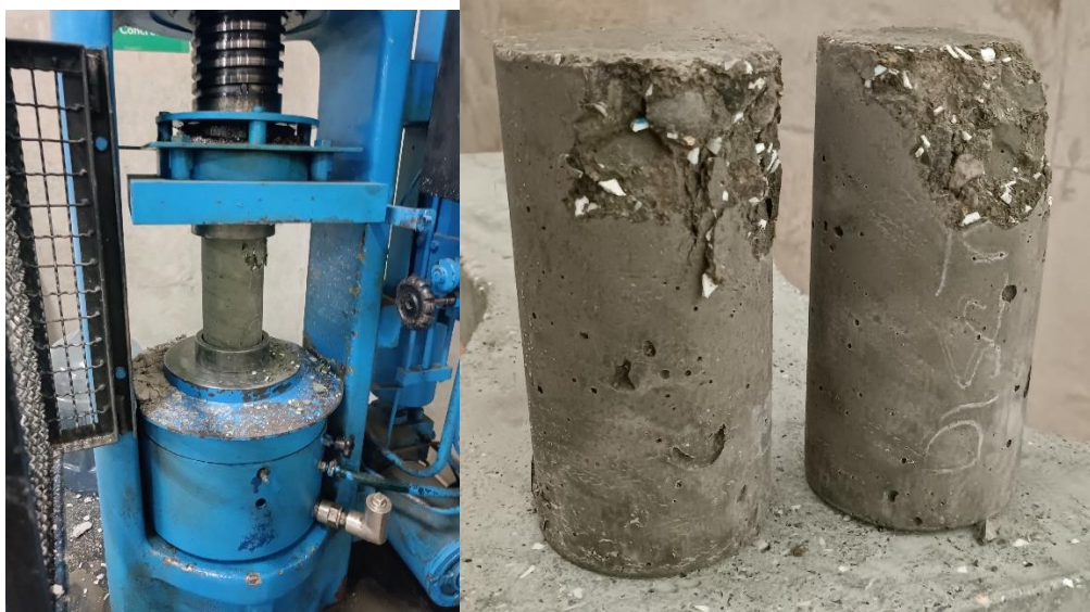
Figura 60. Probeta en la maquina hidráulica y cilindros ensayados
