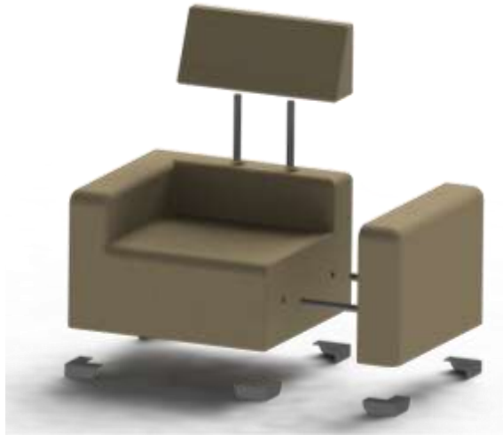
Figura 113. Explosión sillas principales
