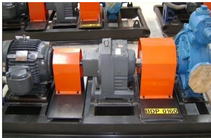
Figura 4. Bomba de desplazamiento positivo tipo paletas
