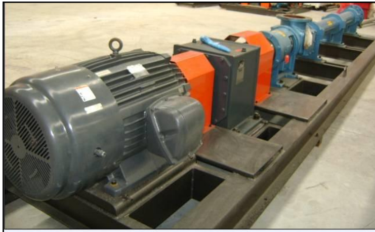
Figura 3. Bomba de desplazamiento positivo tipo tornillo
