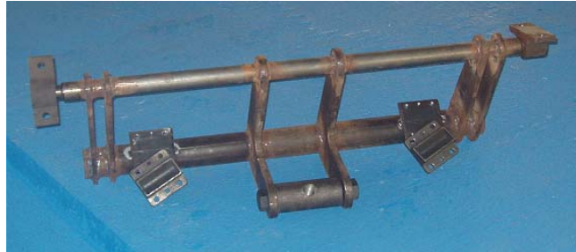
Figura 31. Sistema de inclinación
