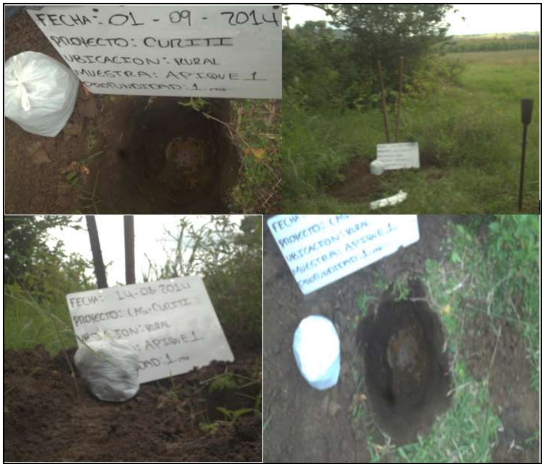
Figura 58. Toma de apiques municipio del Curití.
