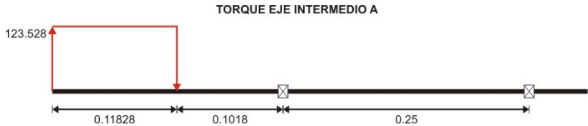
Figura 31. Diagrama del torque del eje intermedio A.
