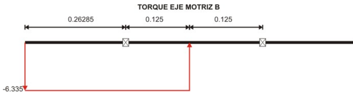
Figura 42. Diagrama del torque del eje motriz B.
