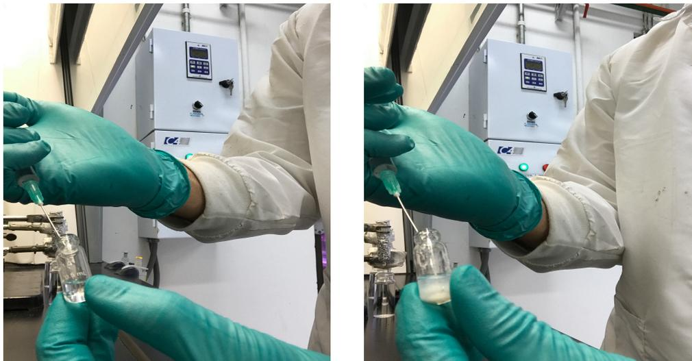
**4. Acondicionamiento:** El acondicionamiento final del soporte que se empleará en el desarrollo de las pruebas de especiación de azufrados, concluye con un lavado final empleando una solución 90:10 de Diclorometano (DCM) – Acetona (ACE). En este momento finaliza el proceso de adecuación del sustrato que permitirá llevar a cabo la filtración química de los compuestos organosulfurosos presentes en el hidrocarburo.
