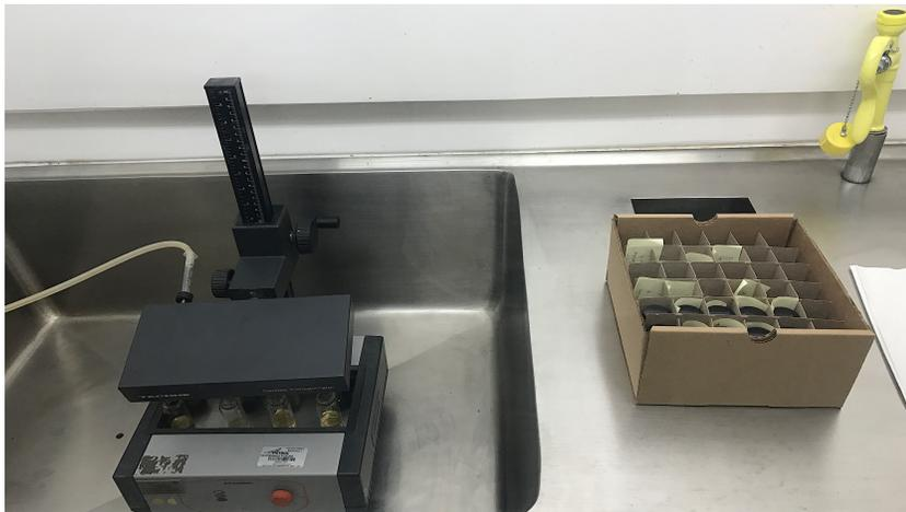
**Figura 37.** Viales con las muestras de las fracciones 1 y 2 posterior al proceso de sacado con nitrógeno.
