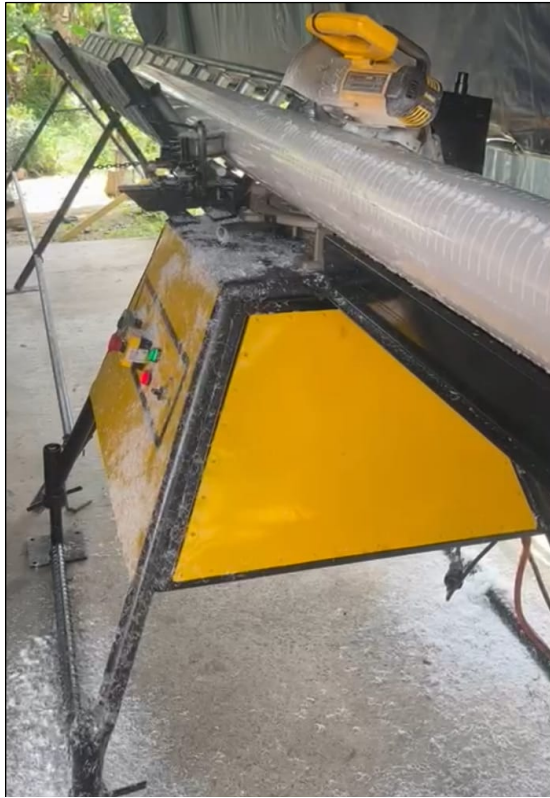
Figura 49. Prueba final de la máquina ranuradora.
