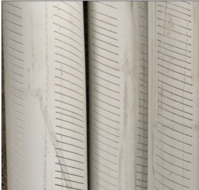
Figura 52. Tubos PVC RDE21 ranurados con máquina ranuradora.
