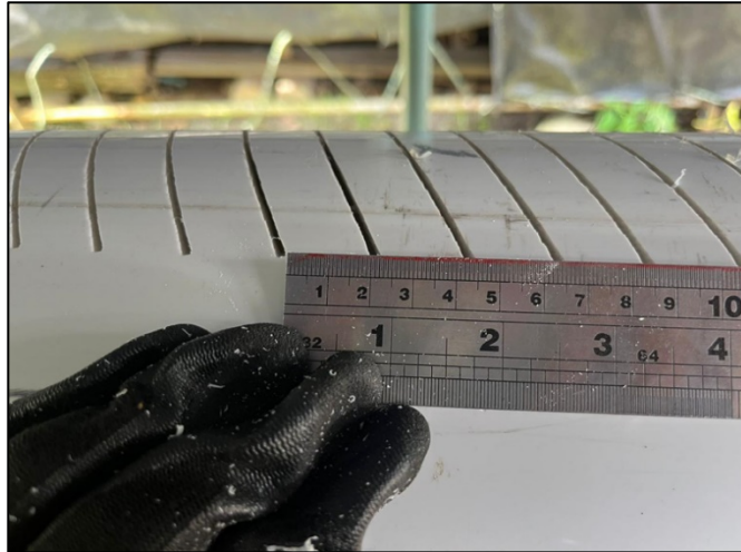
Figura 51. Prueba final de la máquina ranuradora.
