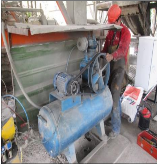
FIGURA 18 Compresor y su unidad de mantenimiento. Fuente: Autor de proyecto
