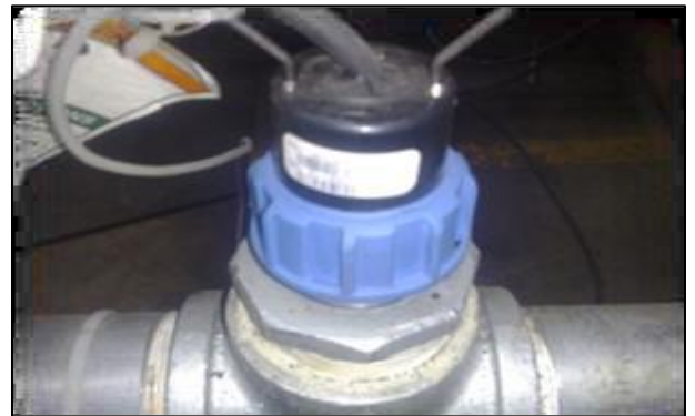
FIGURA 17 Motobomba de dosificación para el mezclador y sensor de flujo Signet. Fuente: Autor del proyecto
