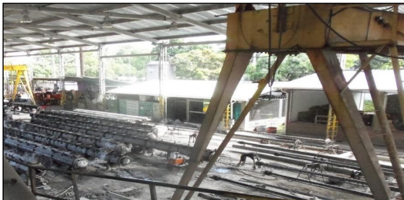
FIGURA 35 Producción de postes de concreto. Fuente: Autor del proyecto
