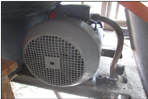
FIGURA 17 Motobomba de dosificación para el mezclador y sensor de flujo Signet. Fuente: Autor del proyecto
