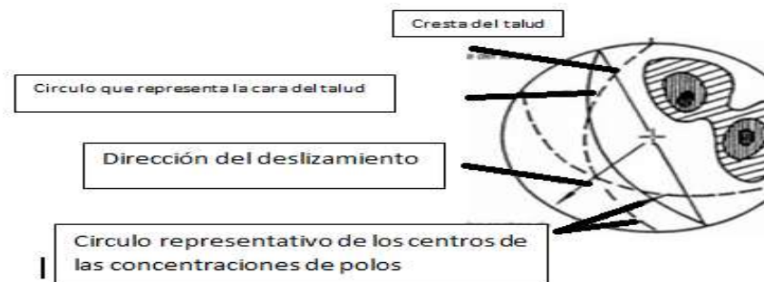
Figura5 Plano estereográfico de un talud
