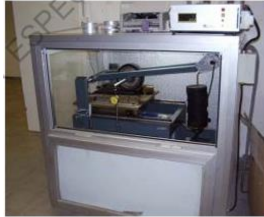
Figura 4. Máquina de pista de ensayo.
