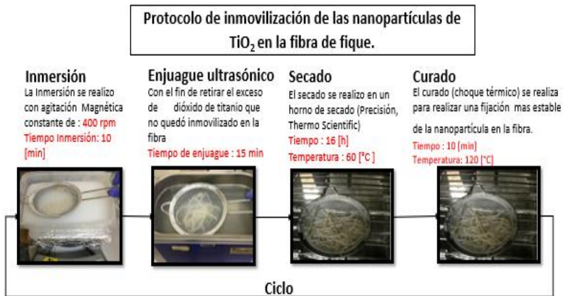
Figura 5. Protocolo implementado en el proceso de Inmovilización de las nanopartículas de TiO 2 sobre fibras de fique.
