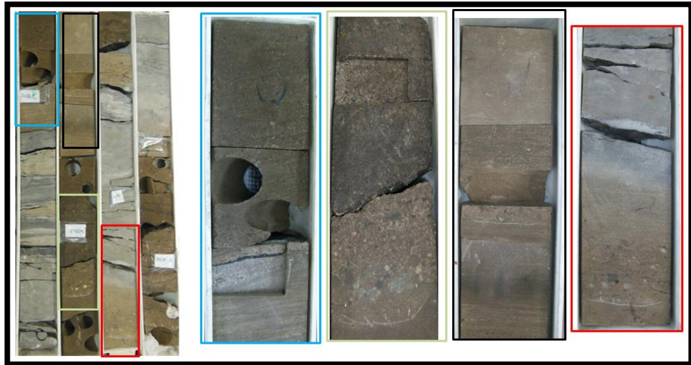
Figura 26. Caballos Inferior. 3439 – 3434 ft. Secuencias granodecrescentes desde conglomerados y areniscas conglomeráticas hasta areniscas de tamaño muy fino y lodolitas. Se evidencian superficies de reactivación.
