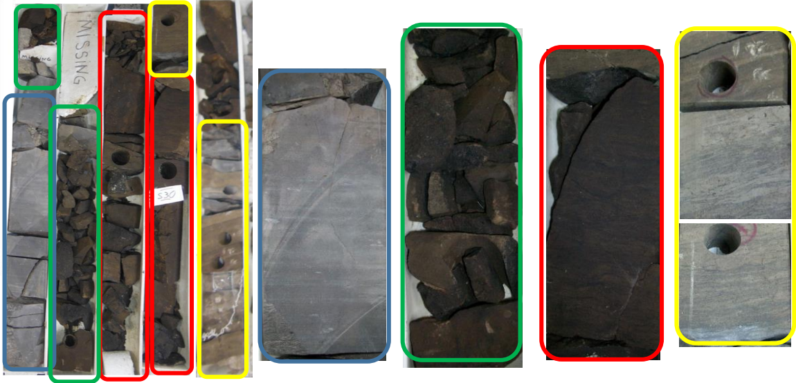
Figura 16. Caballos Superior. 3124 - 3110 ft. Azul) Lodolita masiva. Verde y Rojo) Areniscas de grano fino y medio, con alta y moderada impregnación. Amarillo) Areniscas de grano fino laminadas (Alam)
