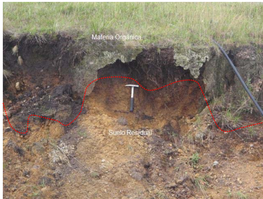
Figura 64. Perfil de suelo desarrollado sobre la formación Rosablanca. Se observa un espesor de 40 cm. de materia orgánica y el suelo presenta un granulometría limosa. Vía El Gramal-Berlín. No se observa roca parental.
