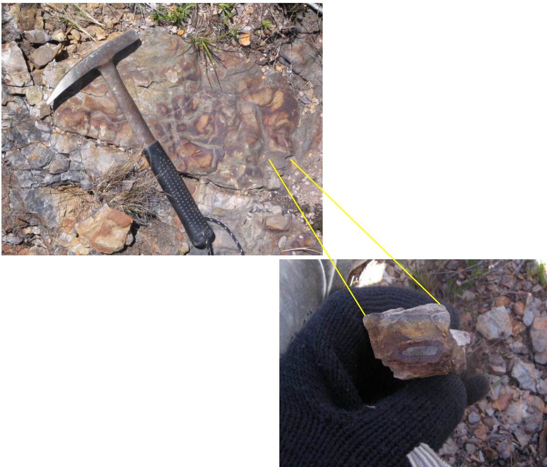
Figura 46. Areniscas presentan alto grado de oxidación. Evidencia sectores con bioturbación.
