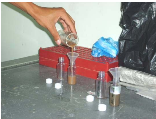
Figura 81. Proceso de embasado de la muestra después de la centrifugada, y preparación de lamina delgada para DRX.
