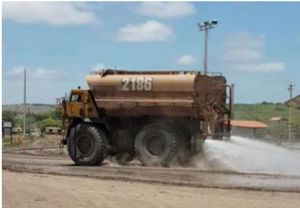
Figura 10. Equipo CAT 777D usado como tanquero. Mina Pribbenow. Adaptado de Marin, Adolfo (2017), Modelo de Gestion de mantenimiento centrado en confiabilidad para el sistema de riego de camiones tanqueros de la empresa Drummond Ltd.
