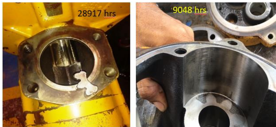
Figura 44. Fotos de algunas bombas de liberación de frenos que han fallado. Drummond Ltd.
