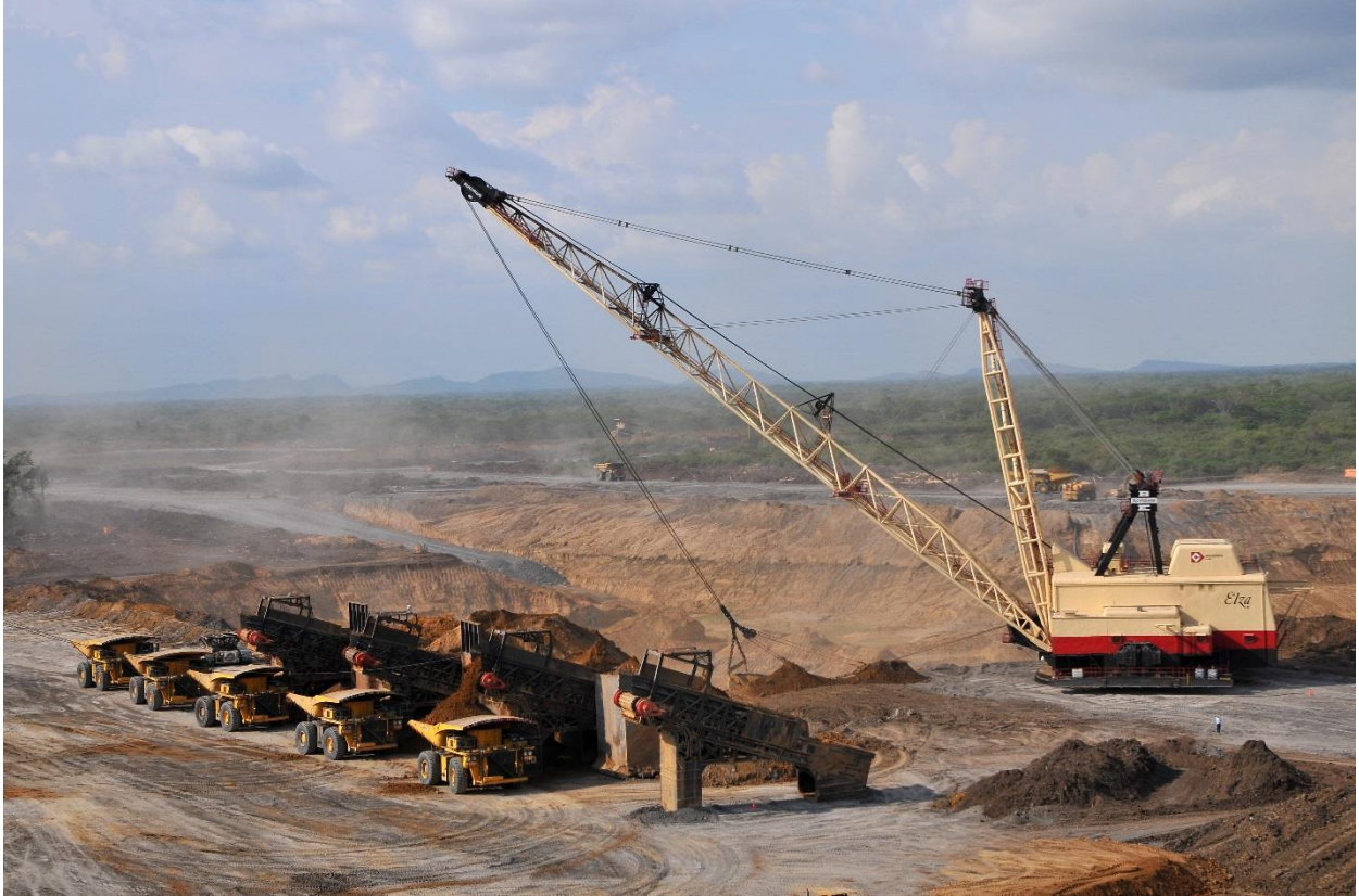
Figura 5. Extracción de aluvión proceso Dragalina – Apron feeder – Camiones Komatsu. Mina El Descanso. Drummond Ltd.
