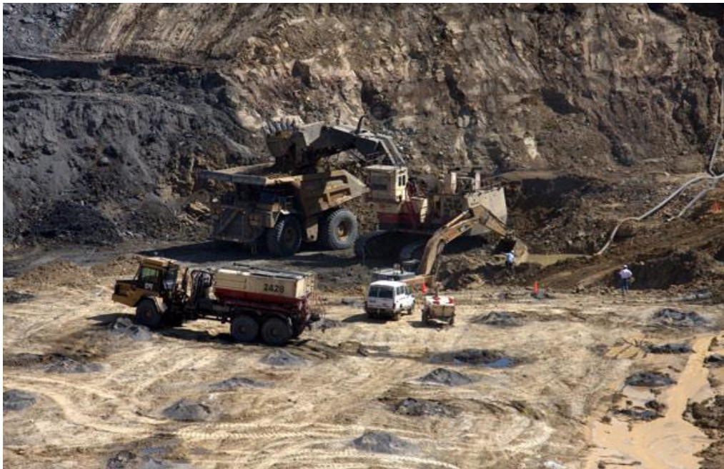
Figura 4. Cargue de camión con pala hidráulica en zona de voladura. Mina El Descanso. Drummond Ltd. Tomado de https://www.drummondLtd.com/nuestras-operaciones/mina
