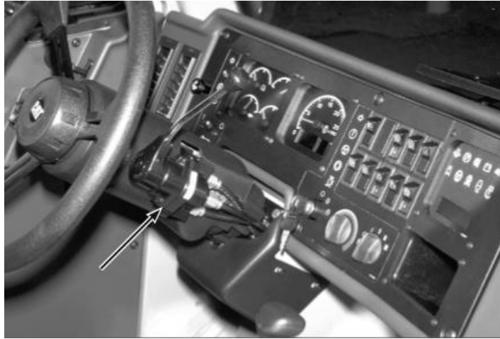
Figura 30. Válvula de retardador manual, ubicada en cabina. 777D update (AGC) off-highway truck, meeting guide 721. CATERPILLAR.
