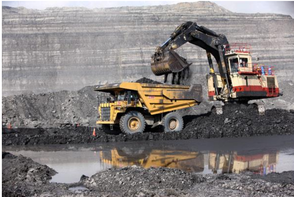
Figura 6. Cargue de carbón, pala hidráulica PC1000 con camión de acarreo 777D. Mina Pribbenow. Drummond Ltd. Tomado de https://www.drummondLtd.com/nuestras-operaciones/mina
