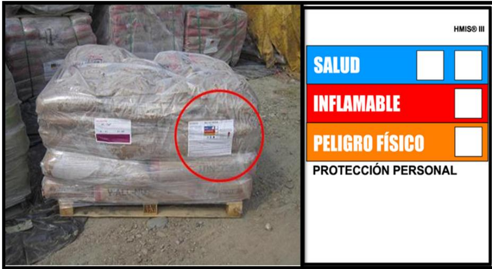
Figura 14. Hoja HMIS III para identificar los peligros de cada producto
