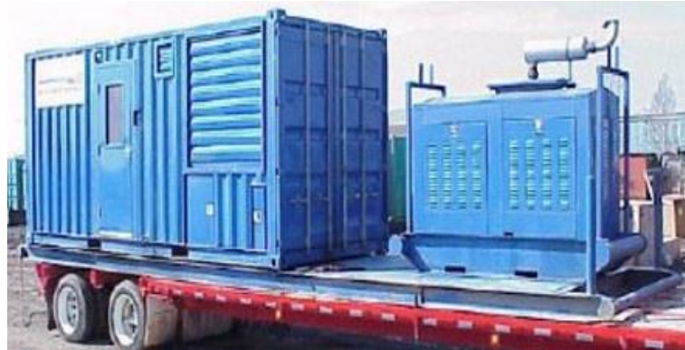
Figura 18. Unidad de compresión de Nitrógeno. Compresor recíprocante Joy WB 11 24
