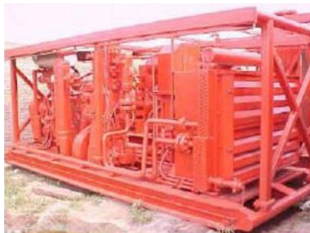
Figura 18. Unidad de compresión de Nitrógeno. Compresor recíprocante Joy WB 11 24
