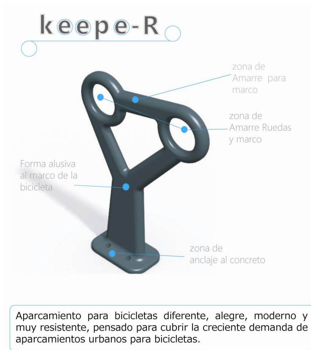
Figura 64. Propuesta final bici estacionamiento
