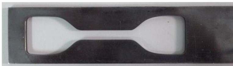
Figura 25. Molde para Prueba de Tensión (Acero 1020)
