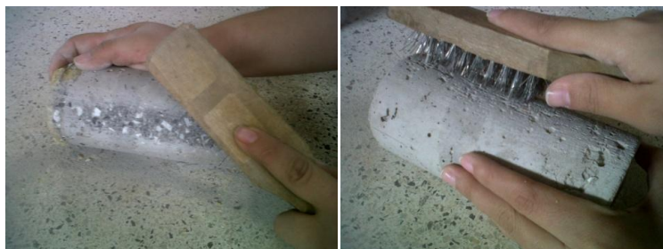
Figura 23. Prueba de abrasión para probetas de concreto
