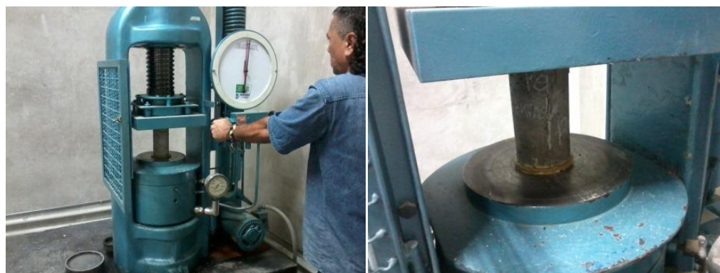
Figura 22. Prueba de compresión probetas de concreto
