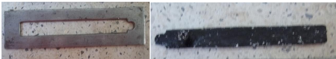
Figura 29. Molde y Probetas para prueba de Flexión
