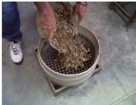
Figura 20. Proceso de tamizaje para granulometría
