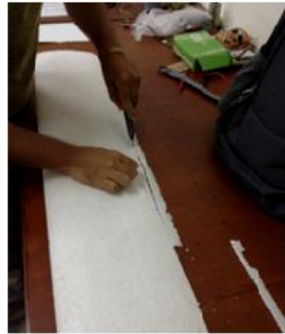
Figura 97. Corte y Armado de las Alas del Aeromodelo
