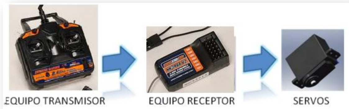
Figura 78. Esquema del Equipo de Radio Control
