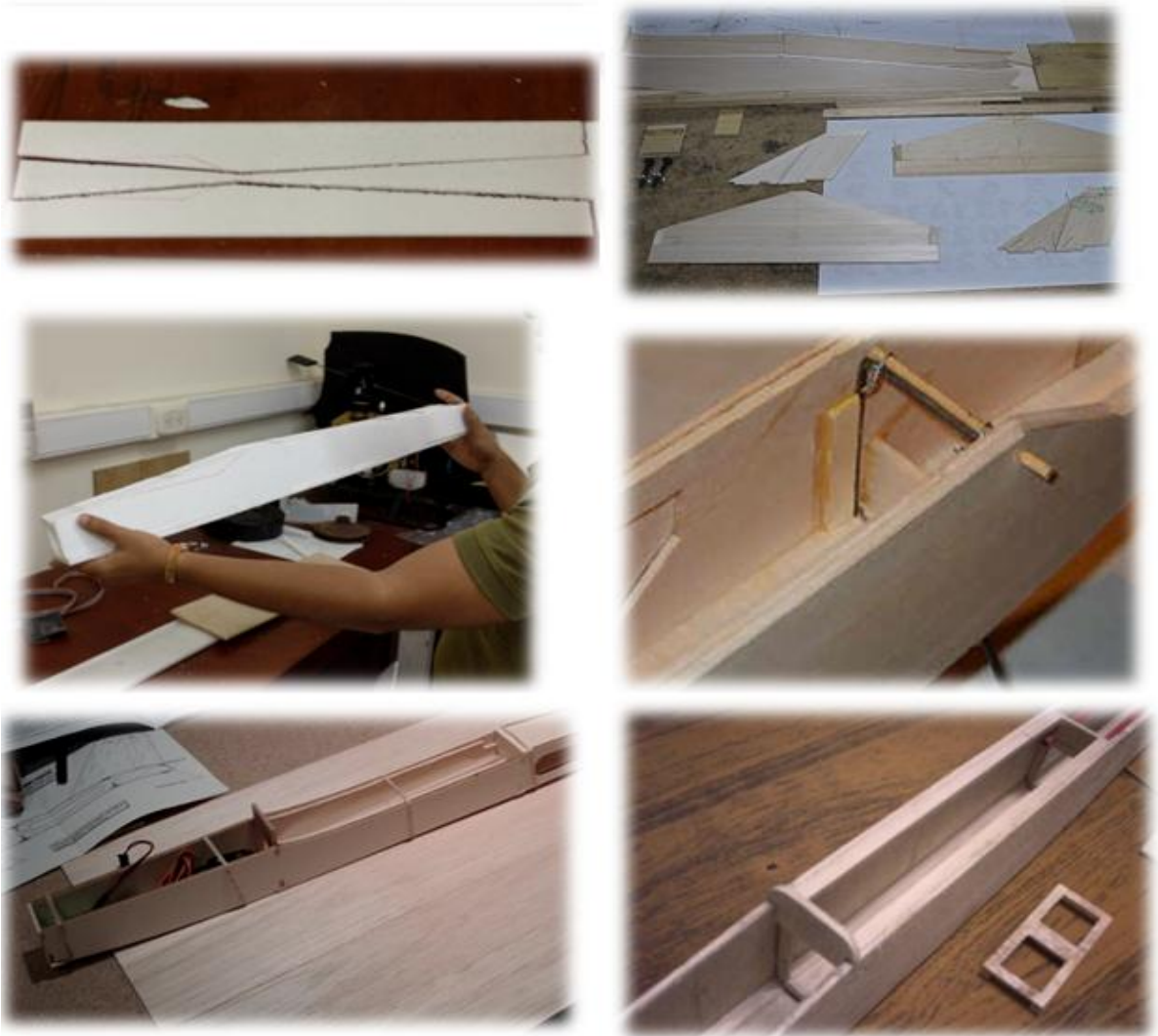
Figura 95. Proceso de Corte y Pegado del Fuselaje
