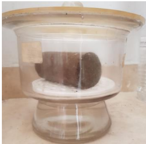
Figura 13. Desecador empleado para el humedecimiento de la probeta.
