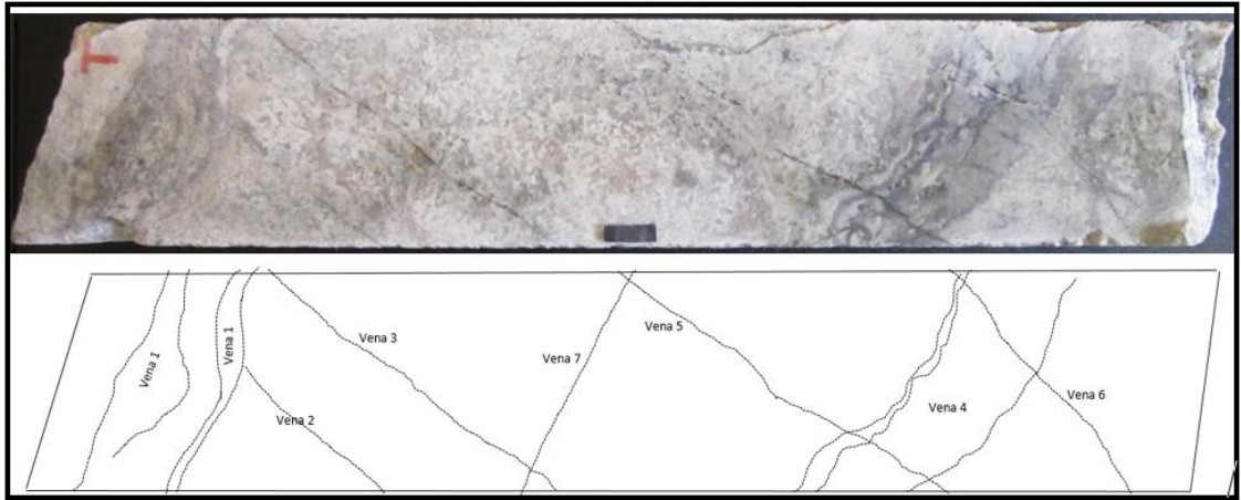
Figura 62. Fotografía y esquema del testigo H242885, donde se observan las diferentes estructuras (venas) identificadas en la muestra.
