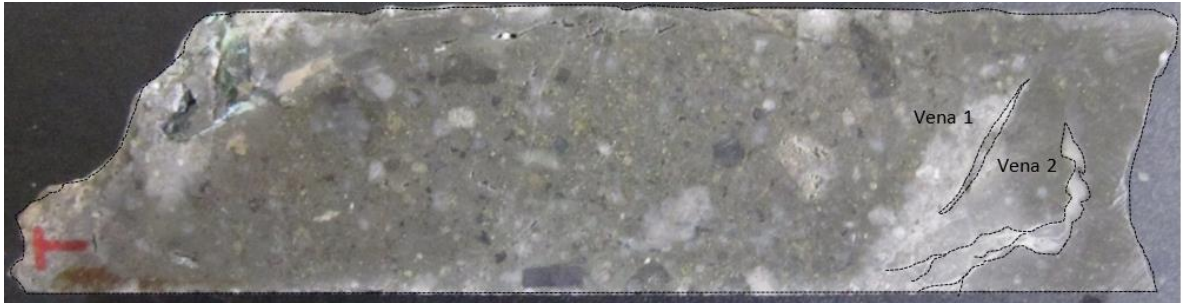
Figura 85. Muestra J301651, donde se aprecian los diferentes tipos de vetillas.
