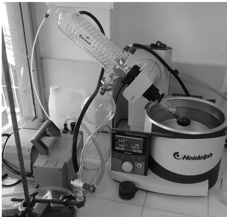
Figura 13. Montaje que se emplea para secar las NPs
