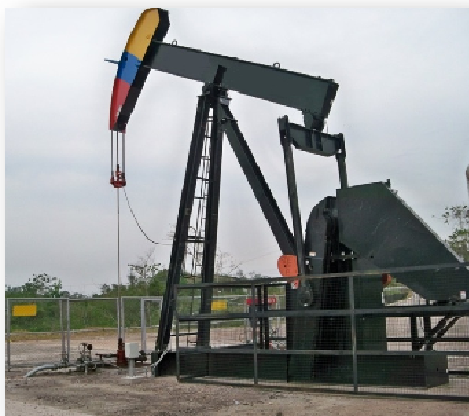
Figura 2 Unidad de Bombeo mecánico tipo convencional
