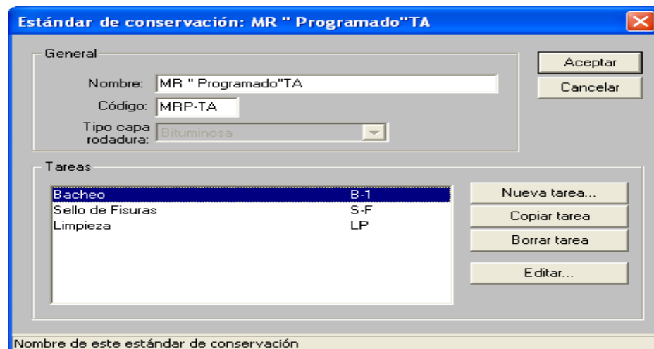
Figura 28. Actividades propuestas en el mantenimiento rutinario.
