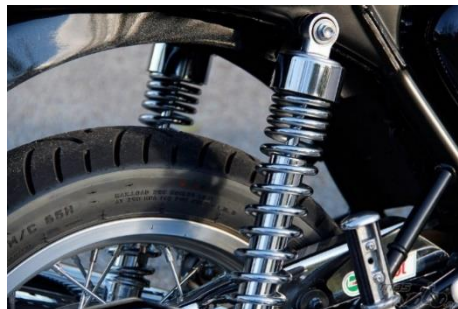
Figura 20. Sistema de suspensión tipo basculante dos brazos
