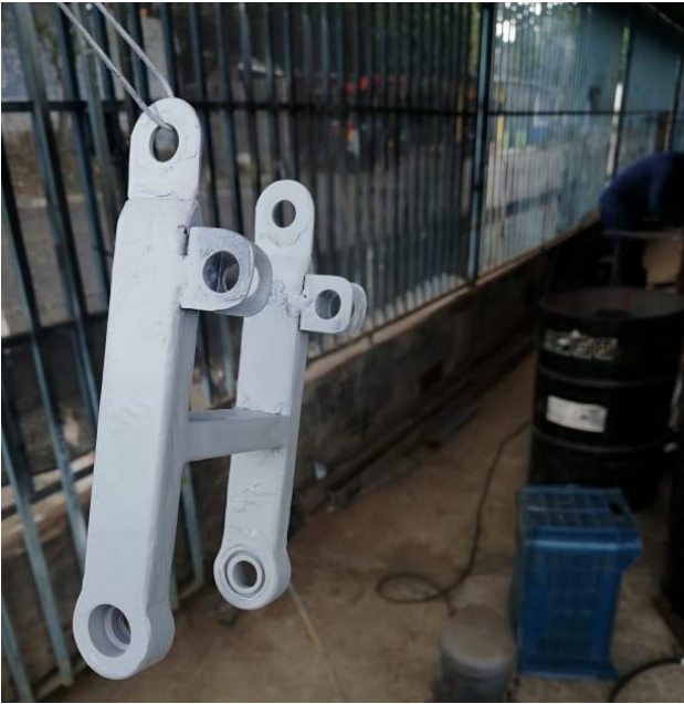
Figura 76. Aplicación de base anticorrosiva al basculante.
