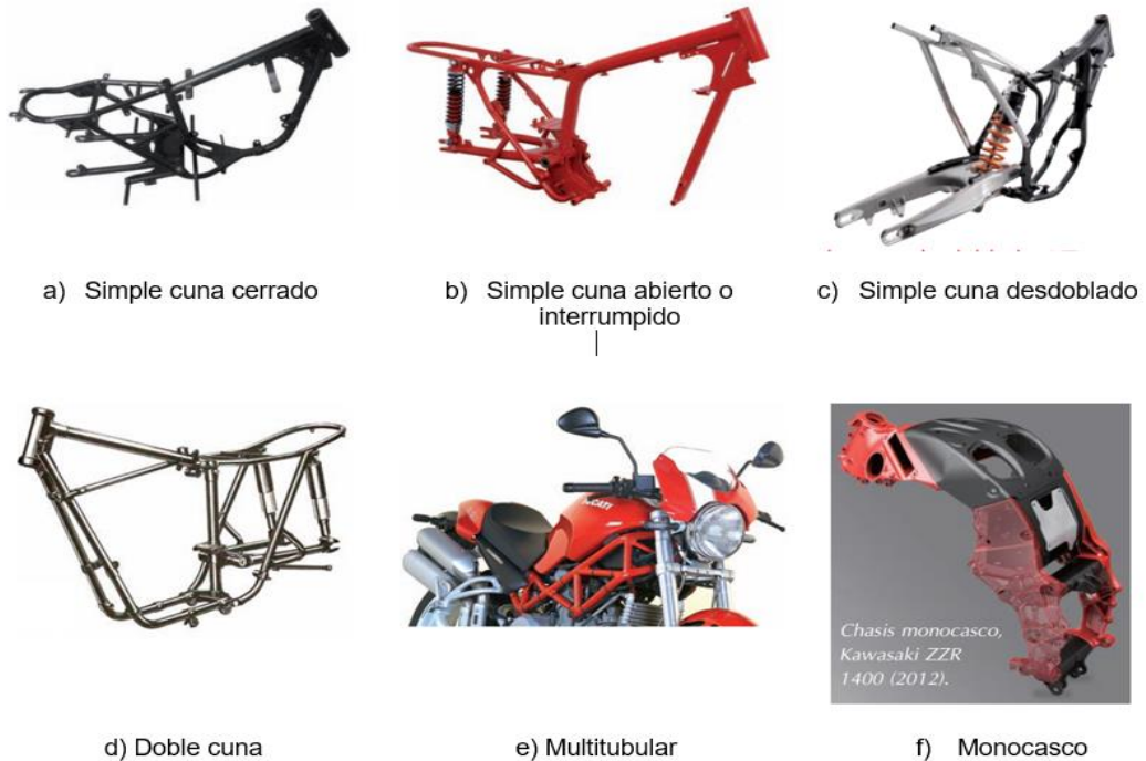
Figura 3. Tipos de chasis de motocicletas
