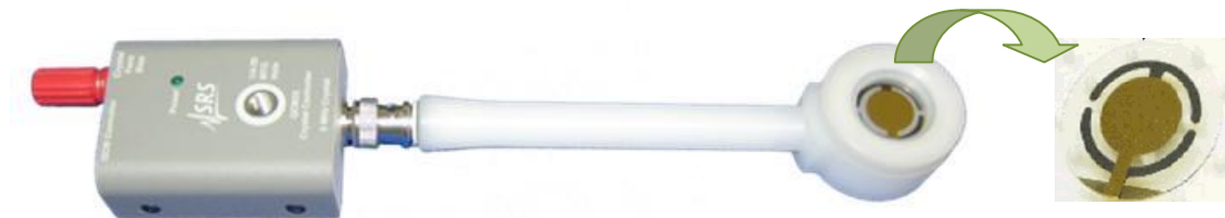
Figura 14. Montaje de holder y cristal de cuarzo piezoeléctrico recubierto con una fina lámina de oro.
