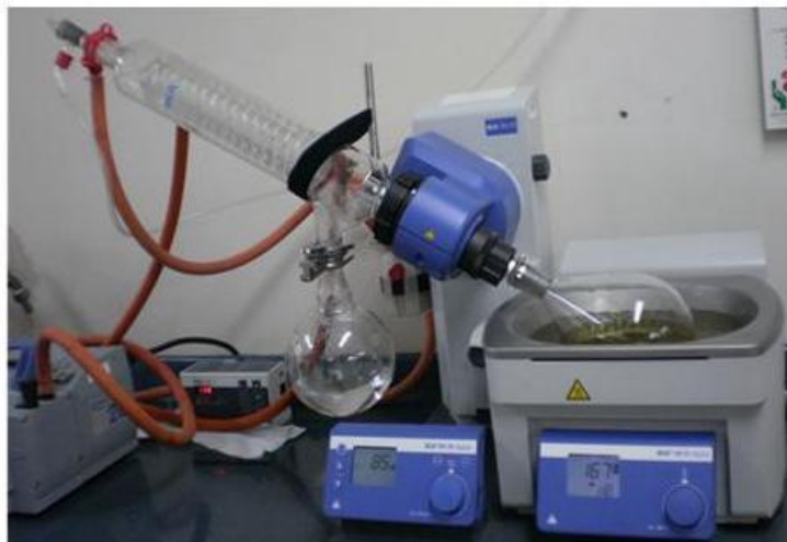
Figura 11. Montaje para la reacción de policondensación de ácido poliláctico.
