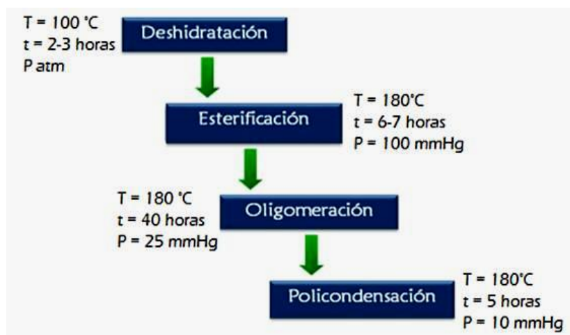
Figura 10. Etapas en el proceso de obtención de ácido poliláctico (PLA).
