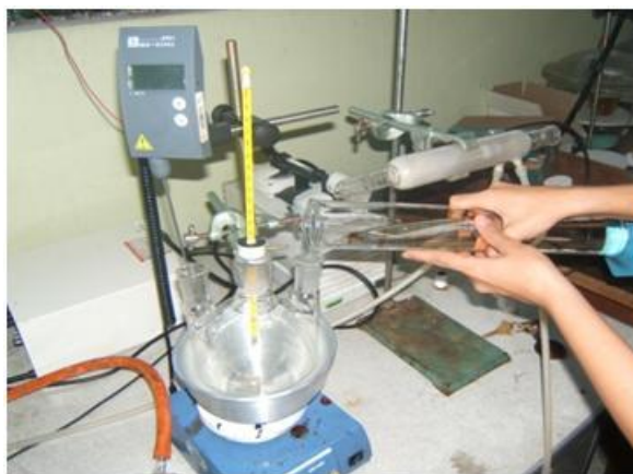
Figura 12. Montaje para la reacción de policondensación de ácido poliglicólico.
