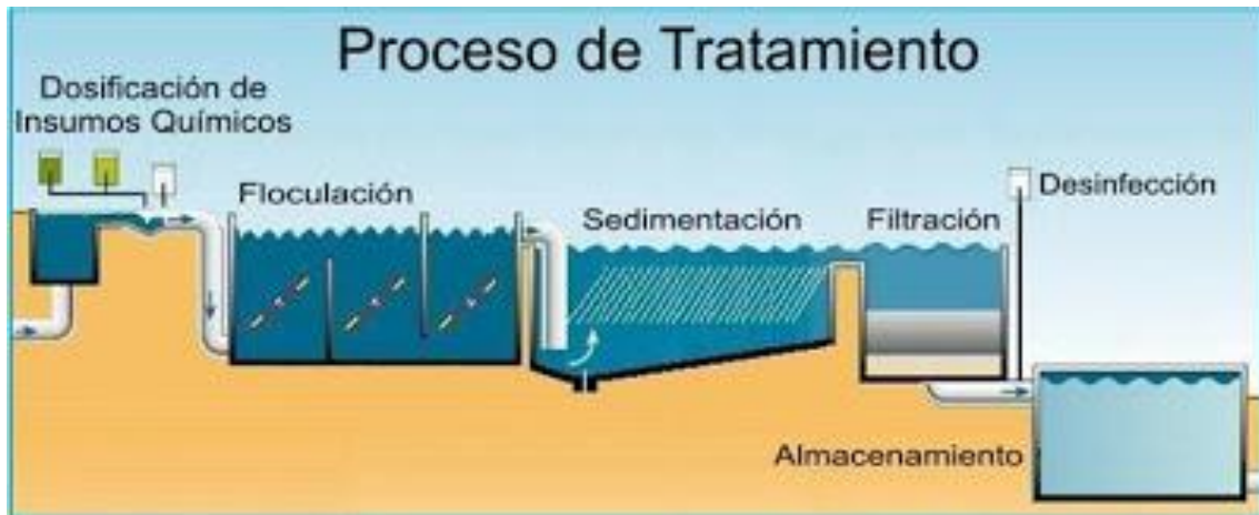
Figura 1. Diagrama General de una PTAP
