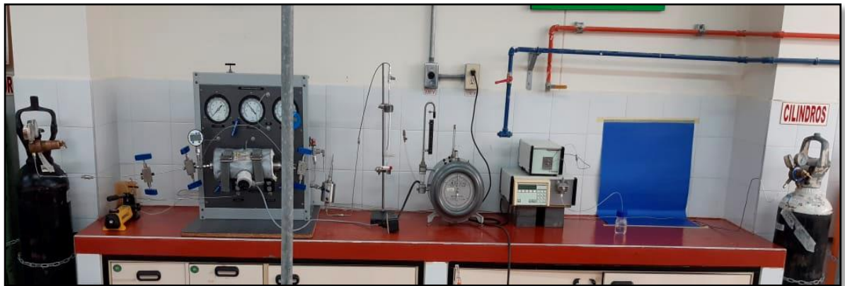
Figura 13 Montaje experimental real para prueba de Adsorción dinámica en laboratorio
