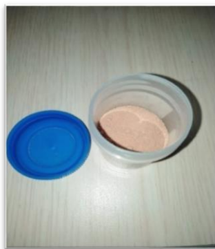
Figura 16 Disco de Arenisca Berea disgregado para prueba de DRX
