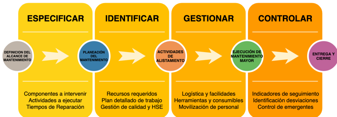
Figura 11. Diagrama de modelo de gestión para mantenimientos mayores
