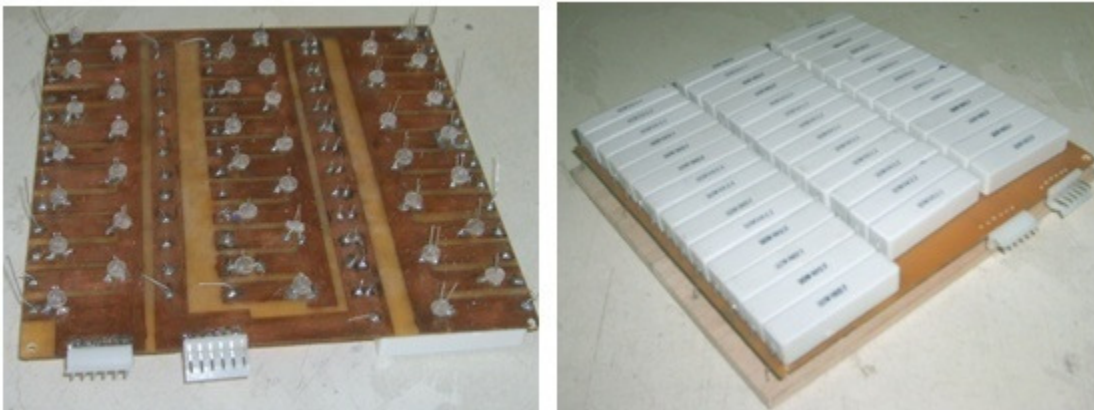
Figura 33: Banco de Resistencias en paralelo ( 8.2\Omega y 20W), caras: anterior y posterior
