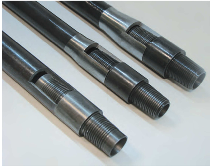
Figura 16. Fotografía de varillas huecas.
