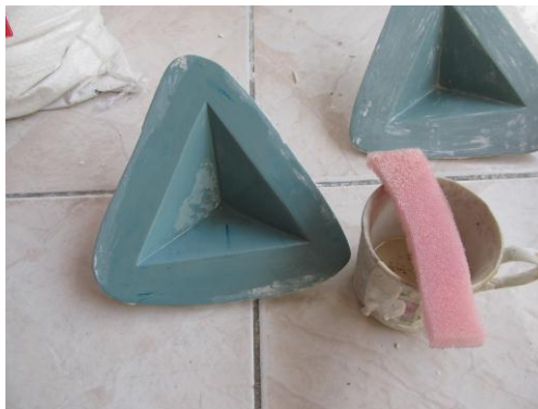
Figura 21. Se aceita las paredes del molde.
