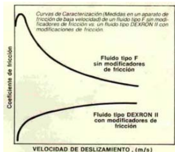
Figura 16. Curvas de caracterización general en un aparato de fricción.
