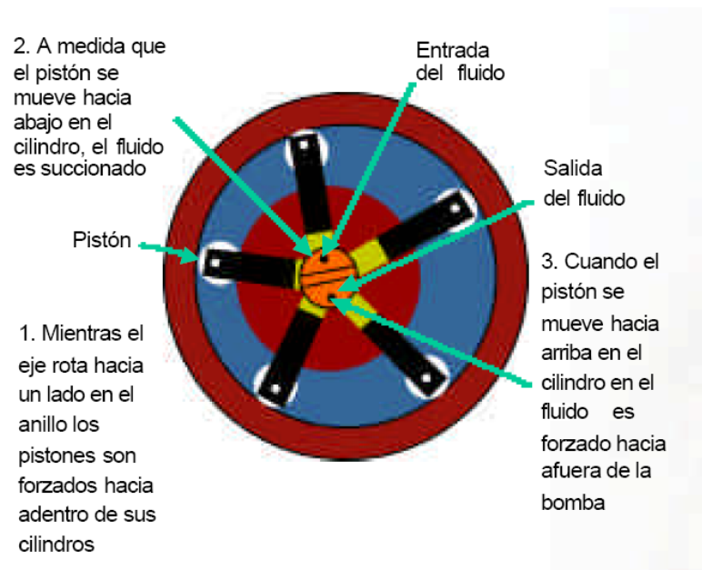
Figura 28. Bomba de pistón radial.
