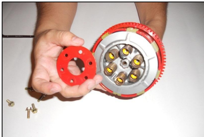
Figura 7 – Retiro elevador de placa.
