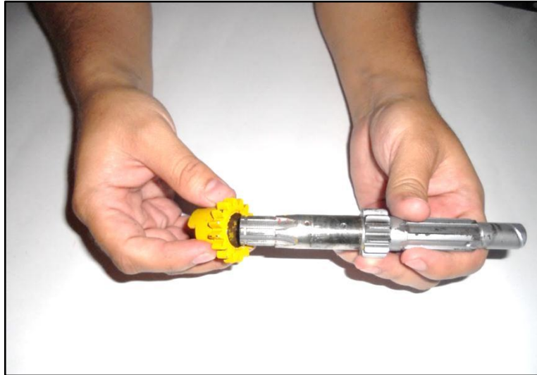
Figura 23 – Montaje del sobre-eje del eje.
