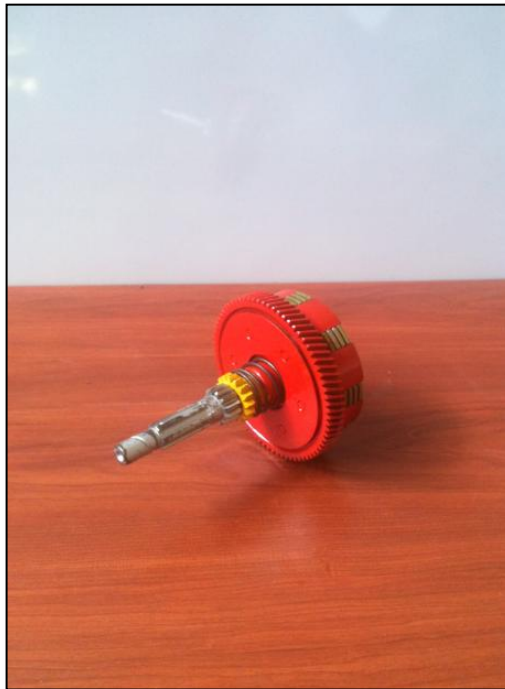
Figura 118 Conjunto embrague en su estado final.
