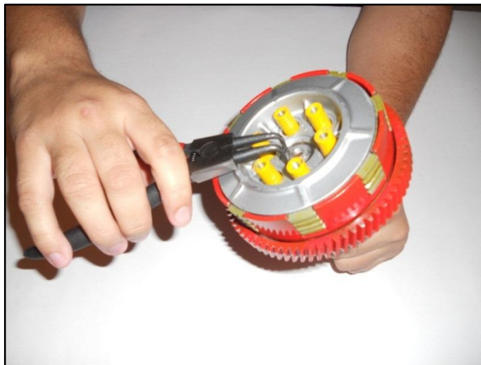
Figura 9 – Extracción del anillo de retención externo
