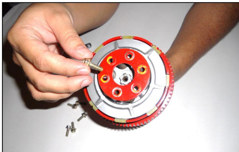
Figura 36- Montaje placa elevadora.
