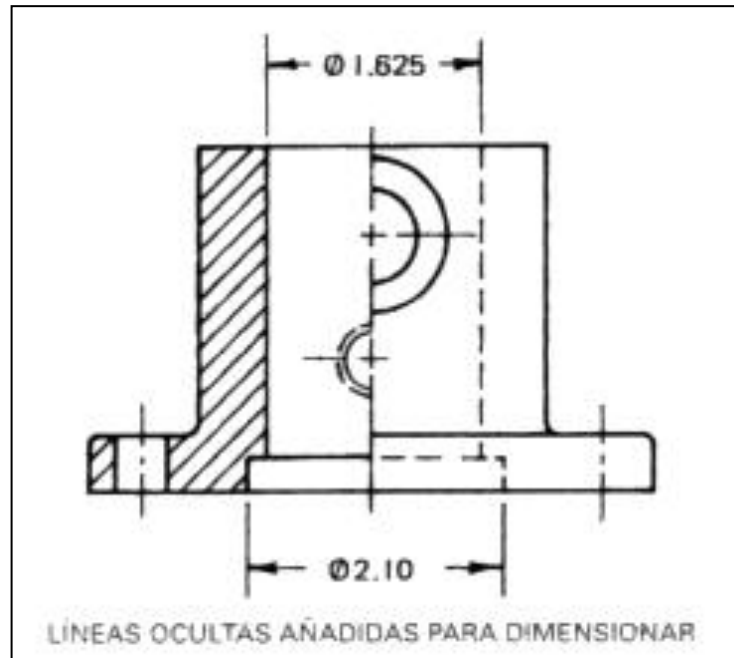
Figura 43 Dimensionamiento en la vista de semisección
