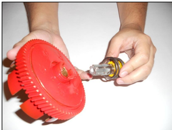
Figura 19- Extracción de la campana
