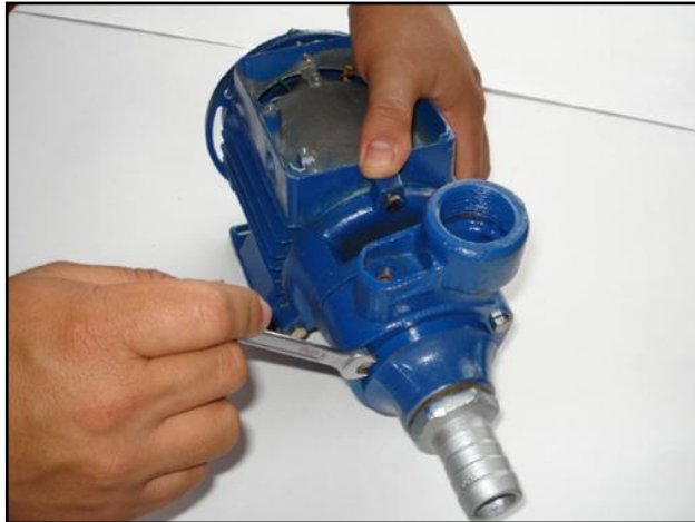
Figura 94 Paso 3 en el proceso de desmontaje- conjunto bomba.
