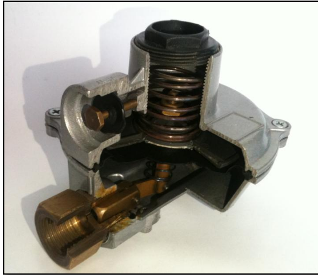
Figura 87 Conjunto mecánico-Válvula reductora para gas natural
