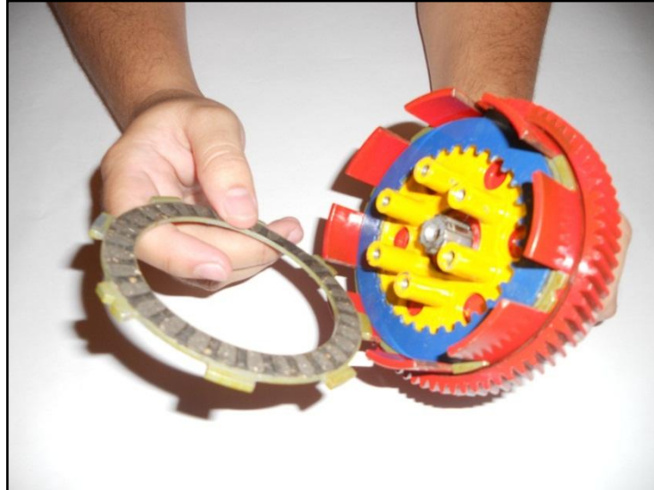
Figura 29– Montaje del segundo disco conductor
