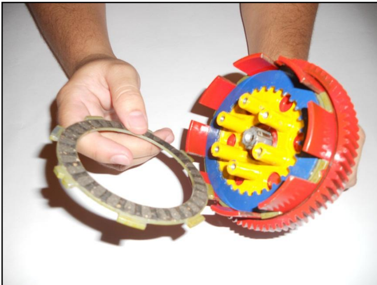
Figura 15 – Extracción del segundo disco conductor.
