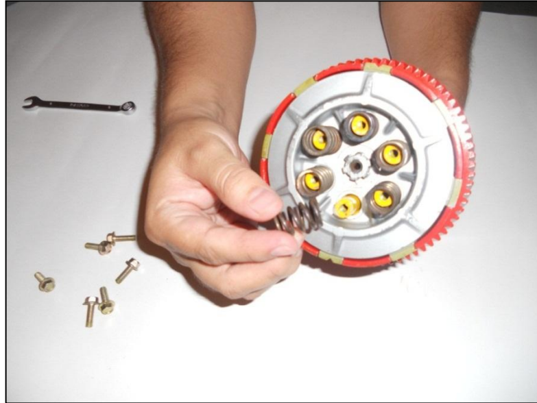
Figura 35 – Montaje de muelles.
