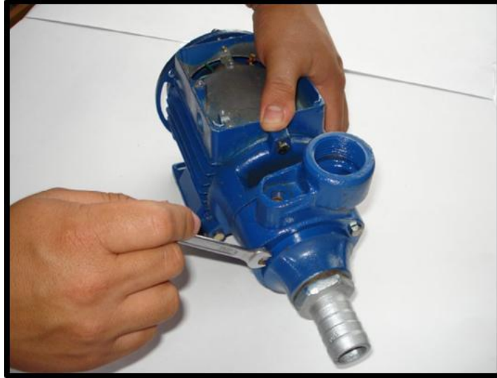
Figura 7- Retiro de tornillos
