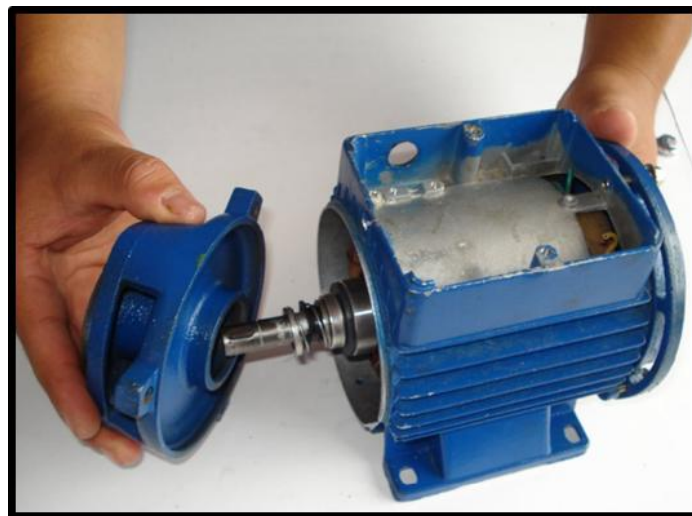
Figura 12- Extracción de carcasa intermedia.
