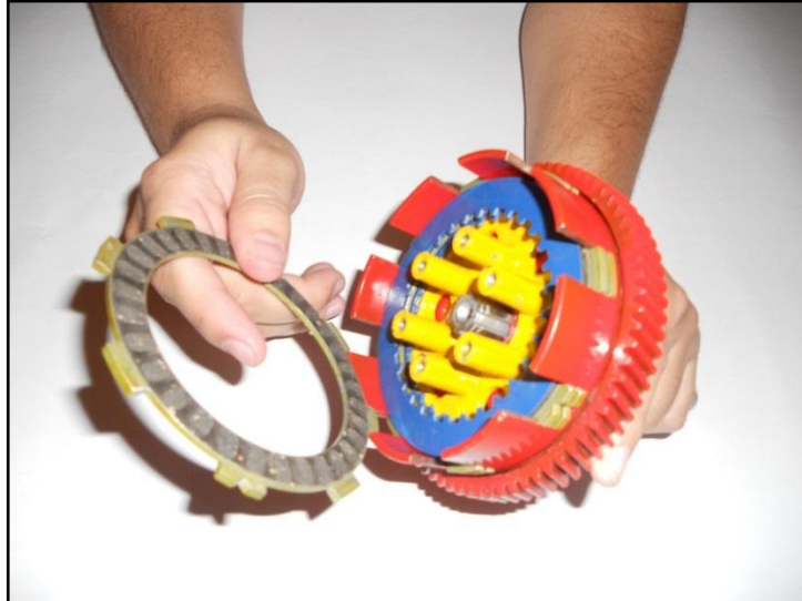
Figura 31 – Montaje del tercer disco conductor.
