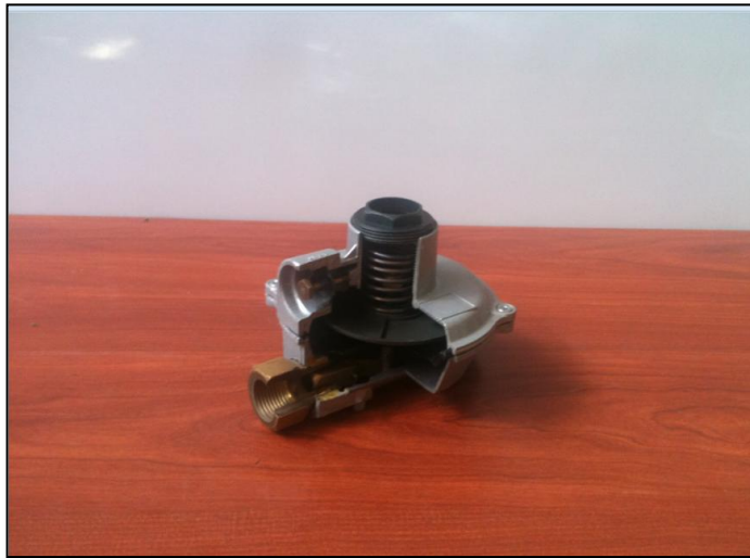
Figura 119 Conjunto válvula en su estado final
