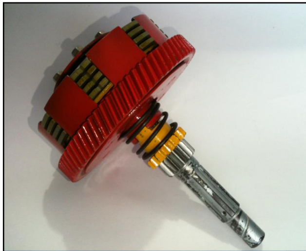
Figura 86 Conjunto mecánico -Embrague de moto
